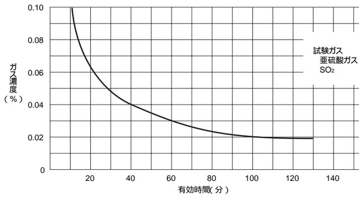
上記の図は、亜硫酸ガスの濃度に対する吸収缶の有効時間を示したものです。作業環境のガス濃度に応じた有効時間を破過曲線図で算定し、使用時間が算定有効時間になった場合は新しい吸収缶に交換して下さい。ガスの種類、温度、湿度によっても差が生じます。
