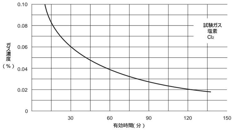
上記の図は、塩素の濃度に対する吸収缶の有効時間を示したものです。作業環境のガス濃度に応じた有効時間を破過曲線図で算定し、使用時間が算定有効時間になった場合は新しい吸収缶に交換して下さい。有効時間はガスの種類、温度、湿度によっても差が生じます。
