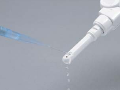
④センサー部を水道水で洗浄する
