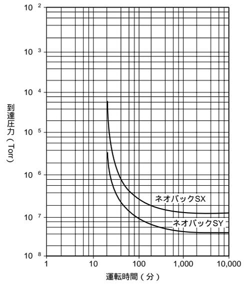
試験方法：4インチ油拡散ポンプ(油回転真空ポンプは800ℓ/minを使用)に試験油を規定量入れ、水冷パツフルを使用し、トラップは使用せずに運転、到達圧力を測定した。
