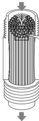
中空糸膜フィルタ構造・電子顕微鏡写真
