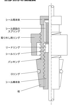
注:1 「栓」は手持のゴム栓、コルク栓等にコルクボーラーで穴を開け、使用出来ますが、専用の栓(テフロン栓、ガラス栓、シリコン栓等)を用意しています。
